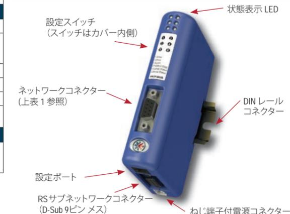
Anybus Communicator IloT は、ネットワーク未対応のシリアル接続機器を OPC UA または MQTT に接続するためのコンバーターです。Communicator IloT は、インテリジェントなプロトコル変換を実行し、ユーザーが作成したデータモデル内で Subscriber にデータを送信します。
