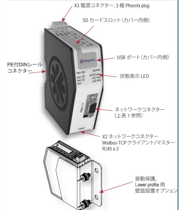
Anybus X-gateway CANopen は、CANopen デバイスを他の PLC システムに統合することが可能です。X-gateway CANopen シリーズは、CANopen マスター (マネージャ) / スレーブとすべての主要なフィールドバスや産業用 Ethernet networks に接続します。高い信頼性と柔軟性により、重要な接続ツールとしてお使いいただけます。
