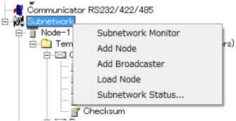
上図を参考に"Subnetwork"上にカーソルをフォーカスし、マウスの右クリックを押します。
