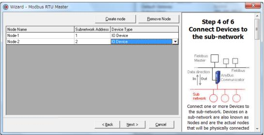
"Device Type"のプルダウンリストから"IO Device" を選択します。 設定を確認し"Next"ボタンを押します。
