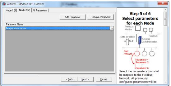
"Parameter Name"のプルダウンリストから"Temperature sensor"を選択します。 "All Parameters"タブを選択します。
