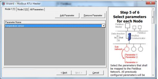
"Parameter Name"のプルダウンリストから "Temperature sensor"を選択します。
