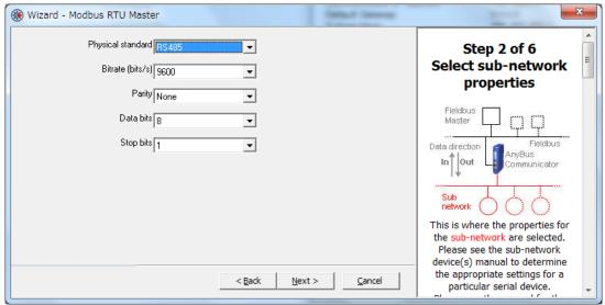
"RS485 "を選択します。その他は、シリアル側の接続デバイスに合わせて設定します。 設定を確認し"Next"ボタンを押します。
