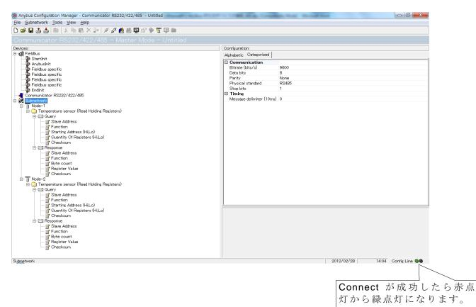
"Wizard - Modbus RTU Master"にて設定されたコンフィグレーションをダウンロードします。 "Download to Communicator RS232/422/485"をクリックします。
