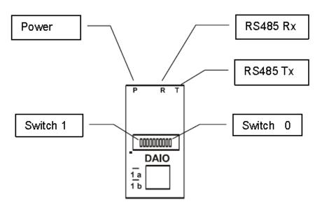
Node の設定は、上図の "Switch1" ~ "Switch0" 間の "Switch1~7" の DIP スイッチを操作することで設定します。On の操作は、DIP スイッチを上側へ倒します。
