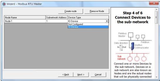
"Device Type"のプルダウンリストから"IO Device"を選択します。 次に Node-2 を設定します。"Create Node" ボタンを押します。
