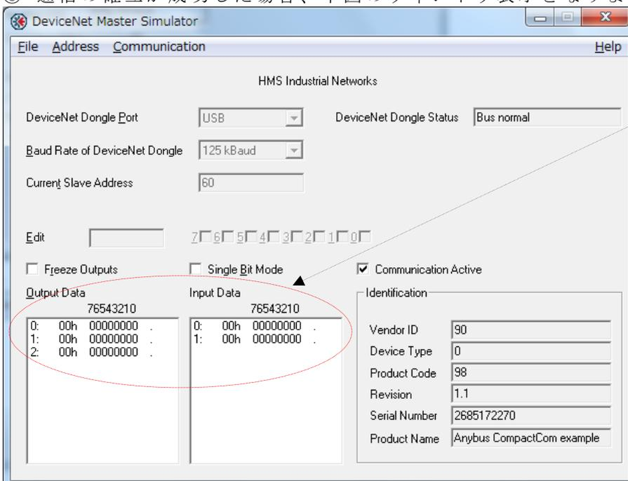
左図の例では、スレーブ側での I/O 設定が Output:3 バイト、Input:2 となっているため、それぞれ Output Data 3 バイト、Input Data 領域に 2 バイト表示されています。尚“Output Data”とはマスタ側（本シミュレータ側）からスレーブ側へ出力される IO データとなります。
