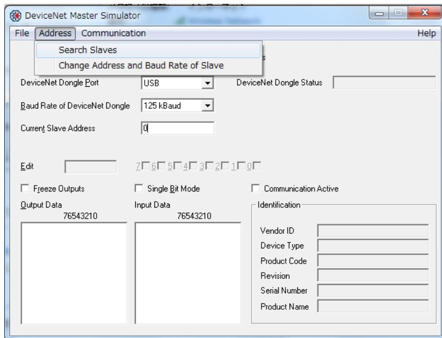
⑤ 検索が成功した場合、接続されているデバイスのアドレスがフォーカス表示されますので“OK”をクリックします。
