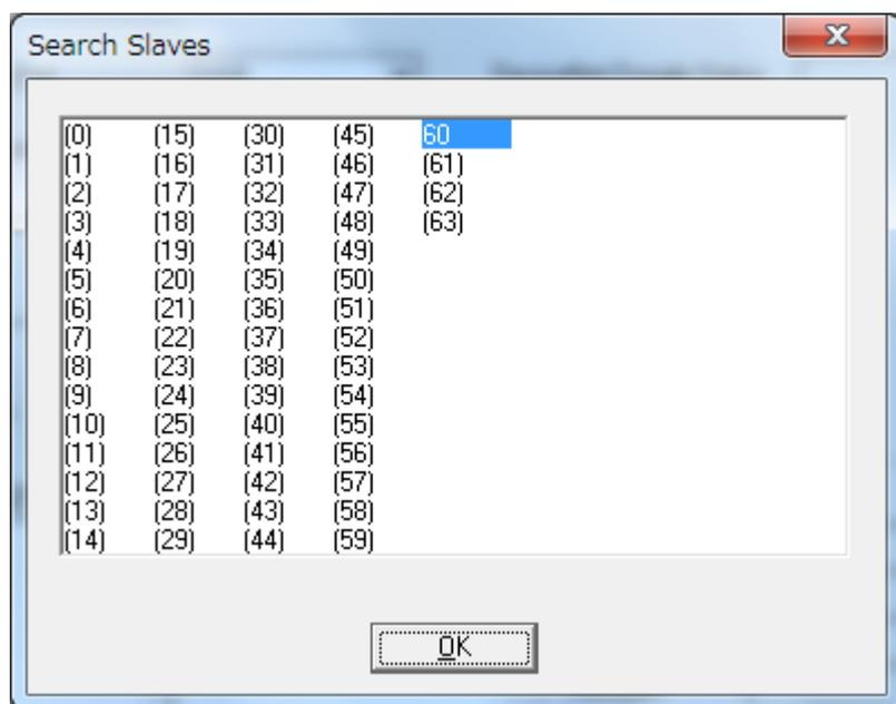
上図の様にフォーカスされたアドレスが表示されない場合は、通信ボーレート：“Baud Rate of DeviceNet Dongle”を“250kBaud”または“500kBaud”に変更し、ステップ④の“Search Slaves”を実行して下さい。
